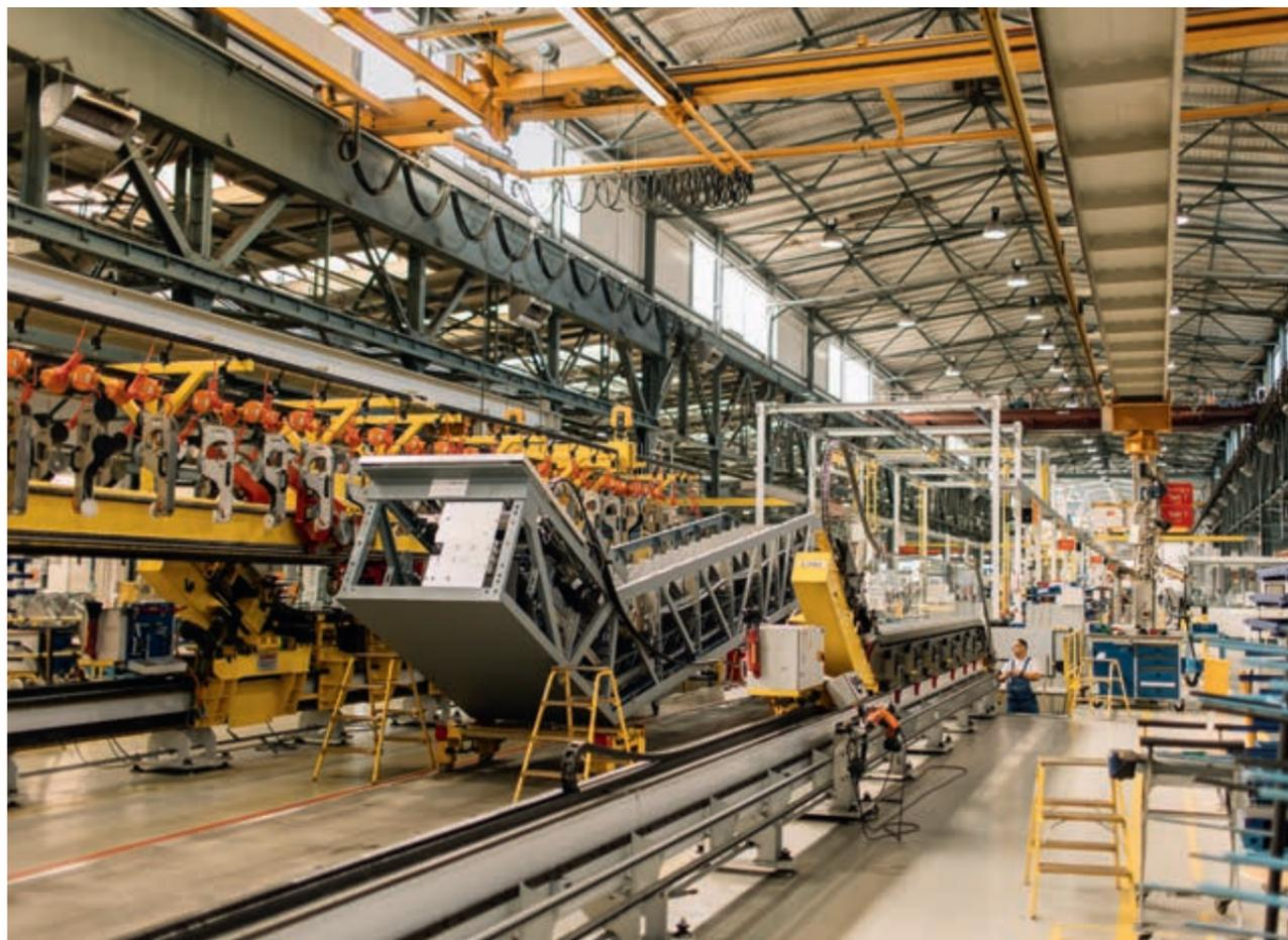
So sieht es aus, wenn eine Fahrtreppe entsteht. Die Produktionsschritte sind in neun Takte unterteilt. Die Treppe ist innerhalb einer Woche fertig.
