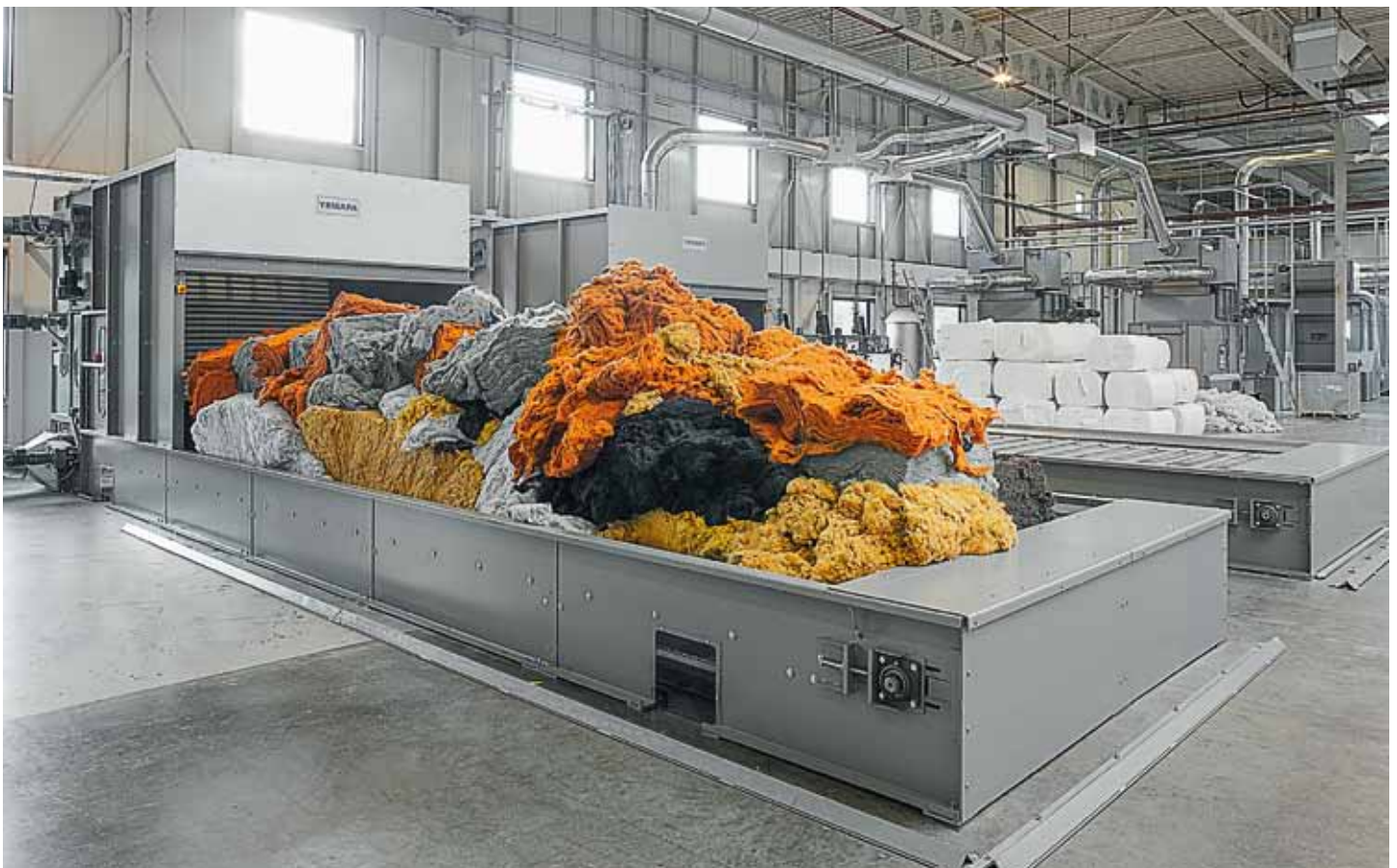
In mehr als 80 Ländern aktiv: Temafa-Maschinen ermöglichen beispielsweise – wie hier im Foto – die Mischung einzelner Rohstoffe in der Produktion von Fasern.
